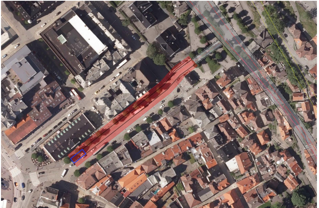
Figur 2-3 - Stipulert omfang av alternativ 2. Åpen byggegrop i dagen vist med rød skravor. Stipulert utgangsbygg ved Kjøttbasaren vist i blått. Fjelltunnel vist i grått. Overgang mellom åpen byggegrop og fjelltunnel er antatt.
