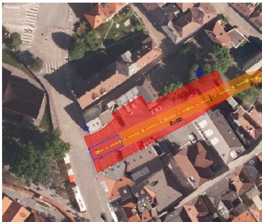
Figur 3-20 - Stipulert omfang i byggetid. Åpen byggegrop i dagen vist med rød skravor. Stipulert utgangsbygg ved Øvre gaten vist i blått. Gangtunnel er vist med oransje skravor. Overgang mellom åpen byggegrop og fjelltunnel er antatt.
