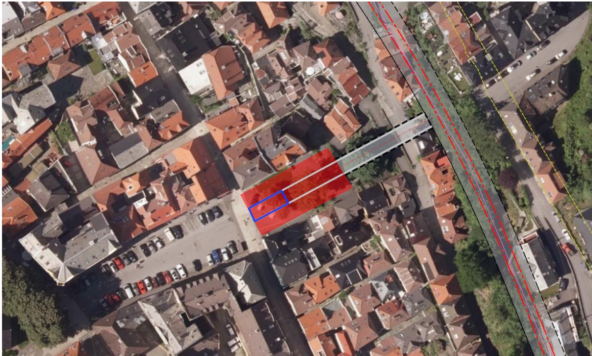
Figur 3-4 - Stipulert omfang i byggetid. Åpen byggegrøp i dagen vist med rød skravur. Stipulert utgangsbygg i øvre del av Korskirkeallmenningen vist i blått. Fjell tunnel vist med grå skravur. Overgang mellom åpen byggegrøp og fjell tunnel er stipulert.
