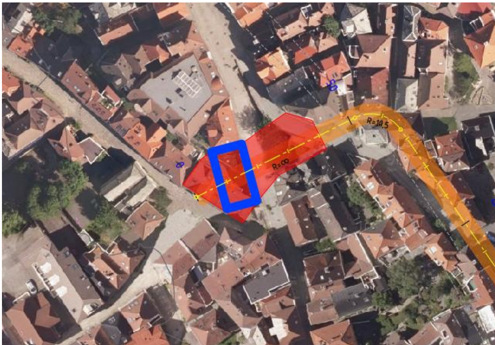
Figur 3-28 - Stipulert omfang i byggetid. Åpen byggegrop i dagen vist med rød skravur. Stipulert utgangsbygg mellom Wesenbergsmauet og Stølegaten/Steinkjellergaten, med mulighet for tilkomst til begge i forskjellig plan, vist i blått. Gangtunnel vist i oransje
